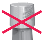
Abrasion métallique prononcée
