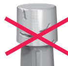
Rayures profondes avec des stries prononcées
